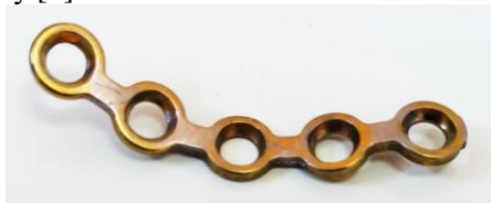
Rysunek 5. Płytkę tytanową MODUS Trauma 2.5, usuniętą z ciała pacjenta po 18 miesiącach [źródło własne]
